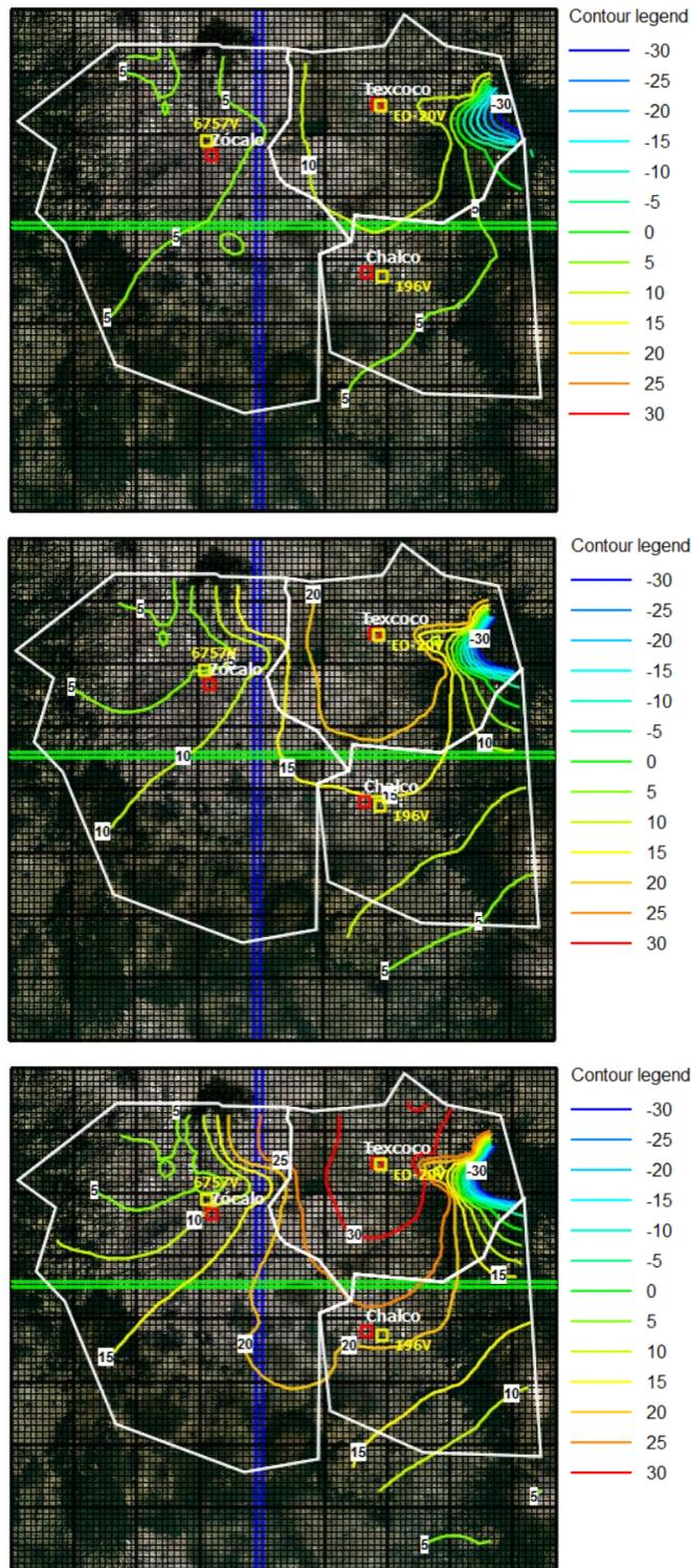
Figura 3.39. Abatimiento simulado con efecto de cambio climático en el modelo ZMCM-Chalco-Texcoco para los años 2030 (renglón 1), 2040 (renglón 2) y 2050 (renglón 3).
